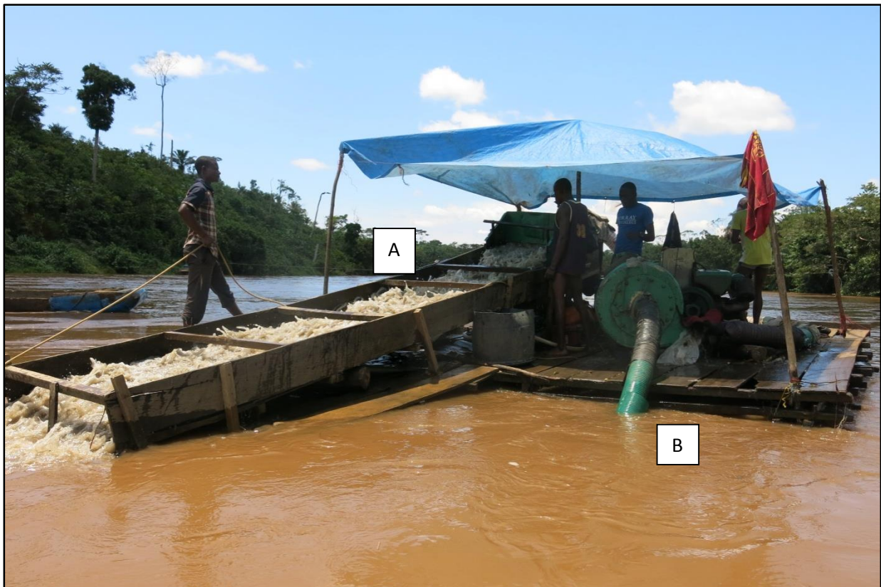
Fig. 2 Drague suceuse œuvrant sur la rivière Ulindi : A) Tuyau d'une longueur de 30 m qui sert à « sucer », extraire le gravier. B) Le gravier passe par un sluice vêtu de tapis retenant l'or fin. Après une rotation de deux heures, le tapis se fait sortir du sluice et il est transporté à la rive de la rivière où il est nettoyé et les particules fines sont amalgamées par l'équipe de lavage.
