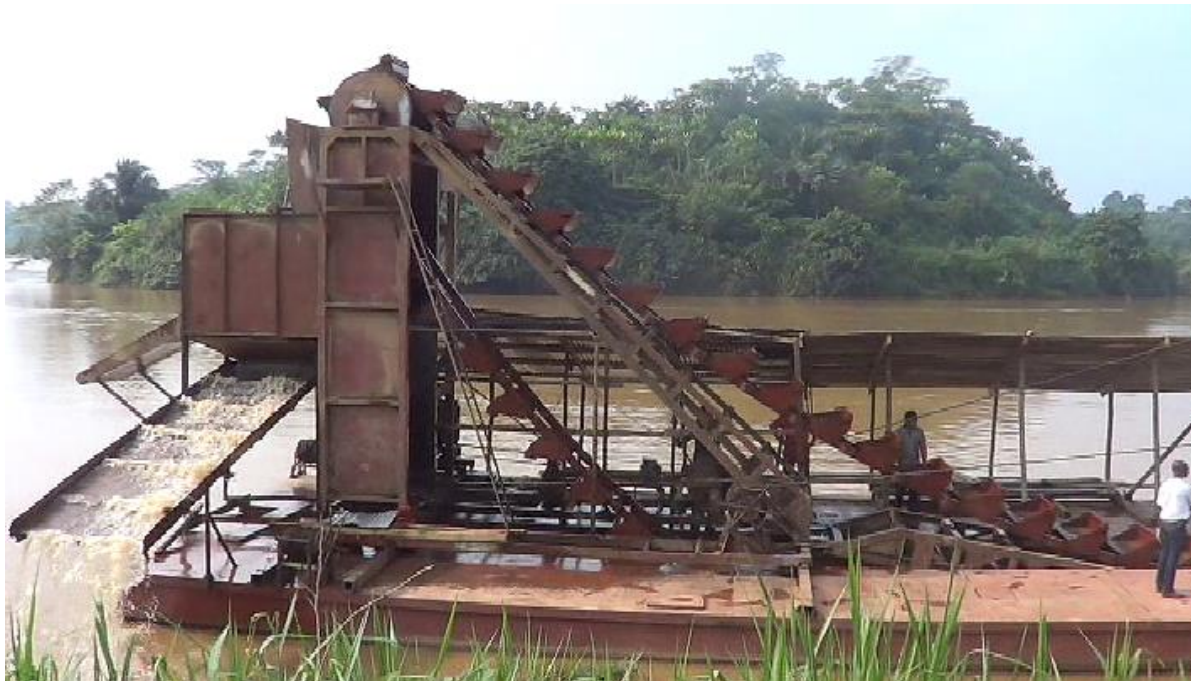
Fig. 3 Drague à chaîne à godets de l'entreprise Kunhou Mining Group opérationnel sur la rivière Ulindi
