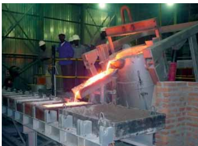
Pouring blister copper, DRC
